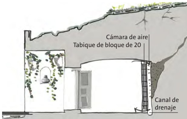
Esquema de trasdosado portante para agua presente en paredes de cueva.
