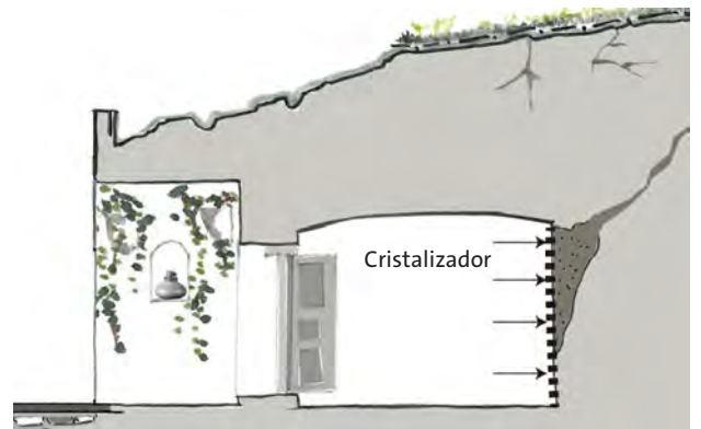
Esquema con aplicación de producto cristalizador (traspirable) para agua presente en paredes de cueva.
